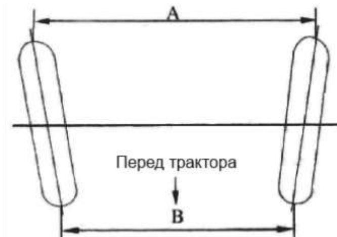
Рис. 3.22. Развал-схождение. Трактор. Вид сверху.
